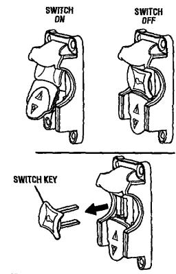
SWITCH IN LOCKED POSITION
